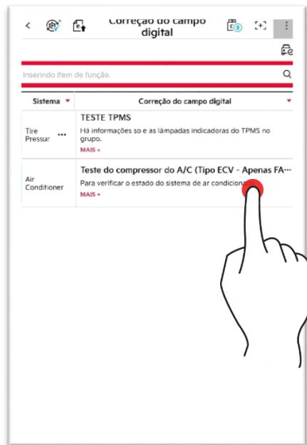
2. Verifique a descrição básica e a condição de teste para o teste e toque no botão “OK”.
