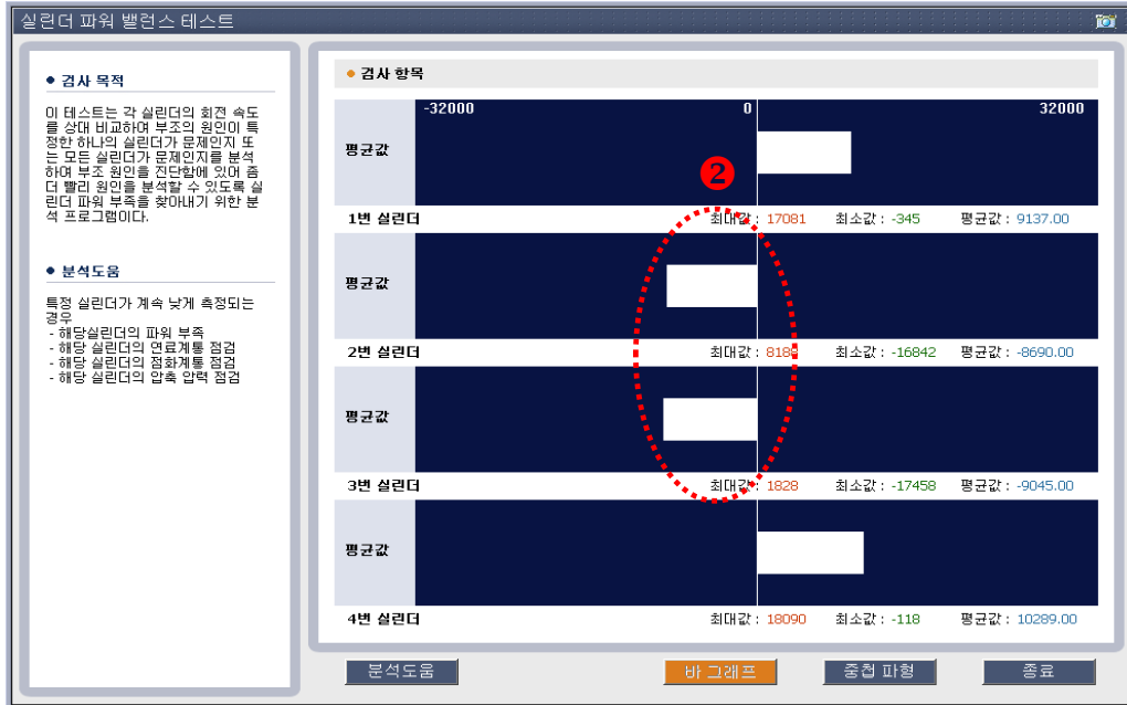
[그림 16] 실린더 파워밸런스 테스트 - 2개 실린더 불량시
