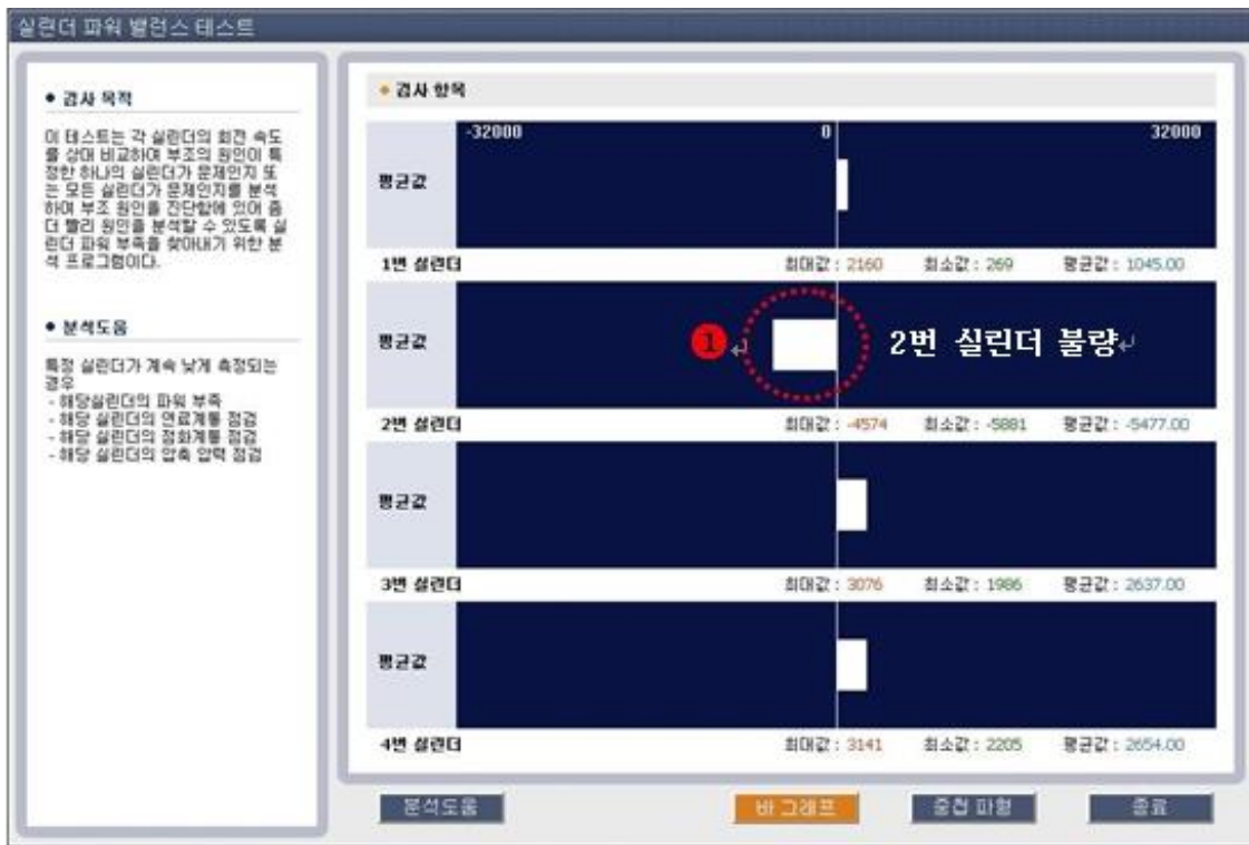
[그림 15] 실린더 파워밸런스 테스트 - 1개 실린더 불량시
