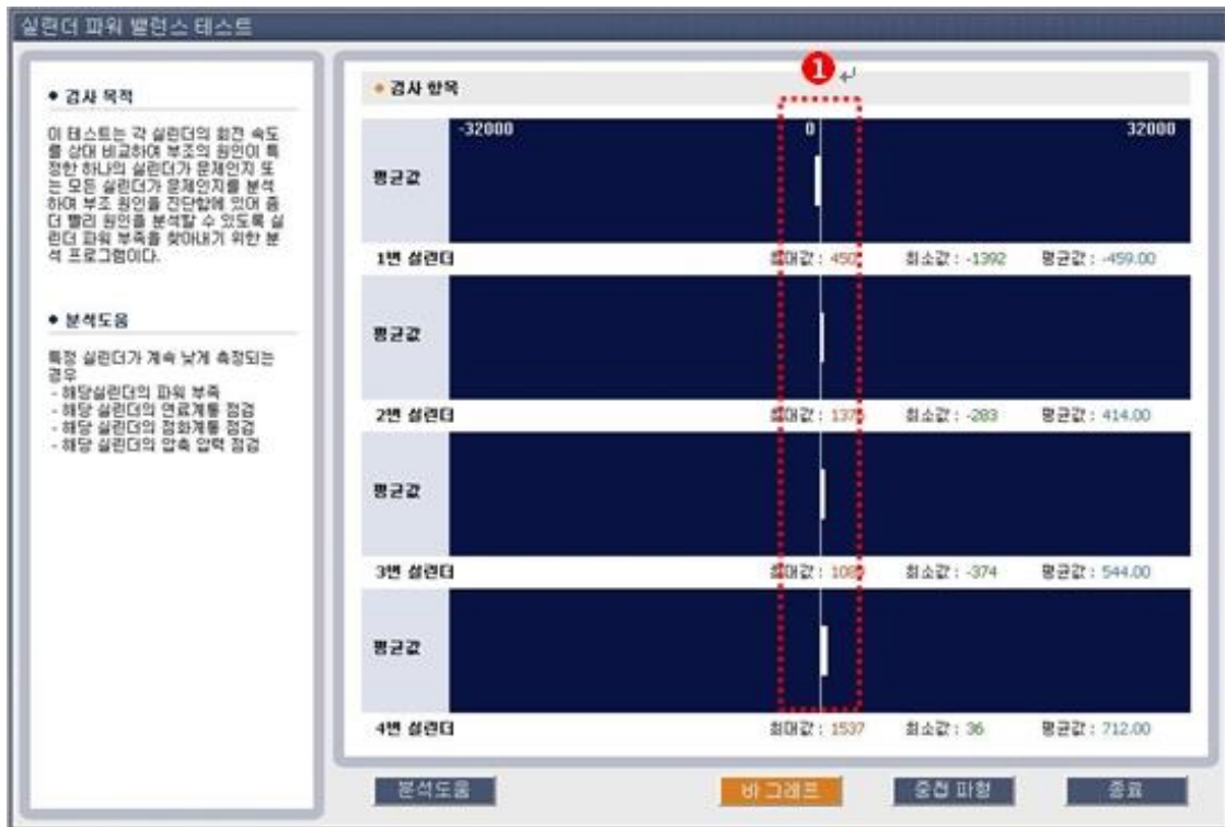
[그림 14] 실린더 파워밸런스 테스트 - 정상시
