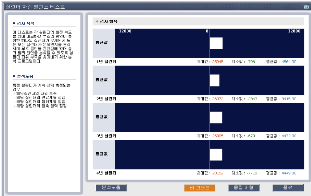
[그림 17] 실린더 파워 밸런스 테스트 - 특정 실린더 불량이 아닌 경우
