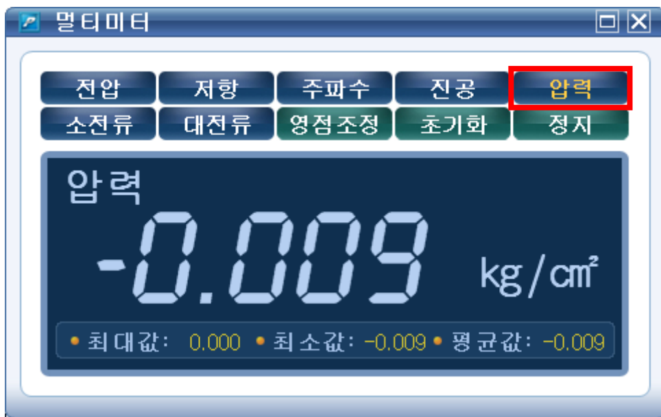
[그림 15] 멀티미터에서의 압력 측정
