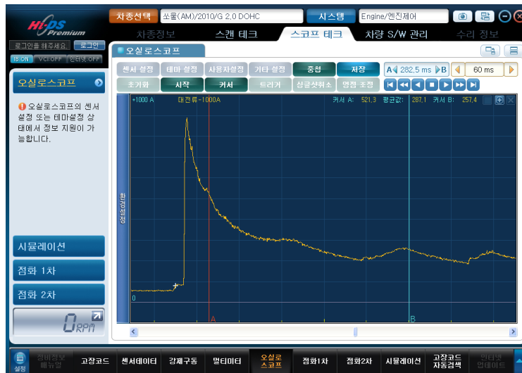
[그림 22] 싱글 샷을 이용한 크랭킹 전류 파형 측정
