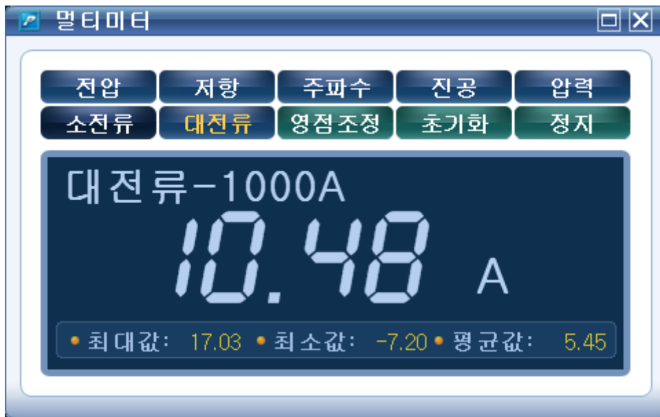
[그림 17] 멀티미터에서의 대전류 측정
