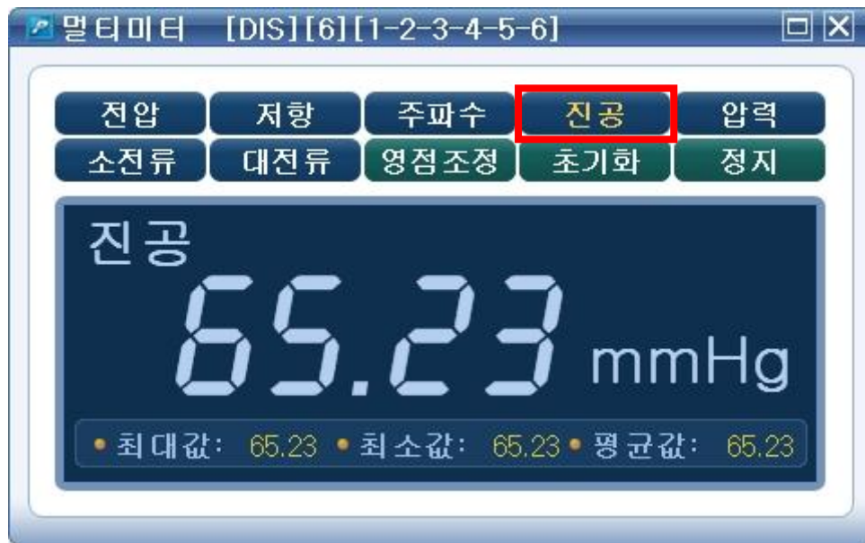
[그림 14] 멀티미터에서의 진공 측정
