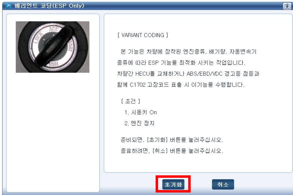
[그림 3] 옵션설정_Variant Coding 기능 실행화면
