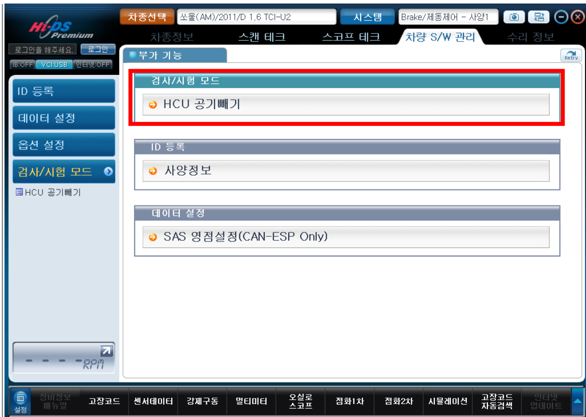
[그림 8] 검사/시험 모드(제동제어)_HCU 공기빼기
