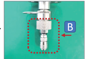
C. 구성품 냉각수로 피팅 B 체결 ※ 테스트간 압력누설이 발생하지 않도록 피팅 B를 피팅 A에 충분히 조여줍니다.
