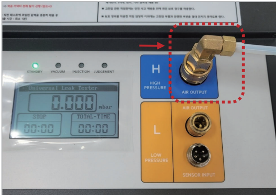
A. 본체 High Pressure Air Output 포트에 구성품 “에어주입 어댑터” 체결.
