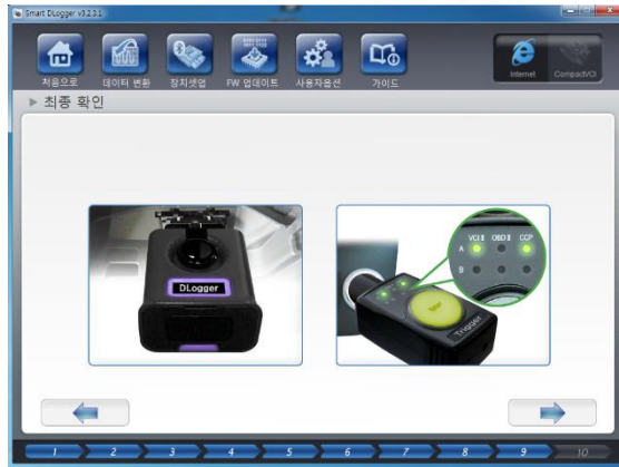
5) CVCI II와 트리거 LED 상태 확인
